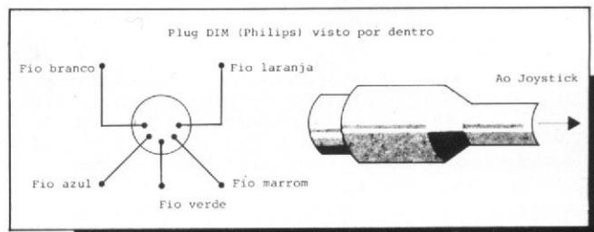
Figura 3 — Ligação dos fios do joystick.
